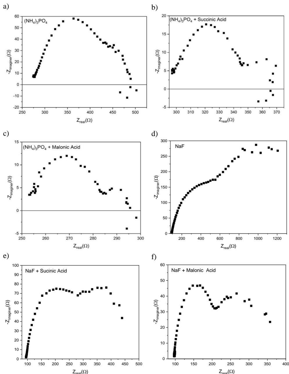
Figure 3 Representative EIS spectra for Mg-5Zn recorded in: (a)  $(\text{NH}_4)_3\text{PO}_4$ ; (b)  $(\text{NH}_4)_3\text{PO}_4$  + Succinic Acid; (c)  $(\text{NH}_4)_3\text{PO}_4$  + Malonic Acid; (d) NaF; (e) NaF + Succinic Acid; and (f) NaF + Malonic Acid
