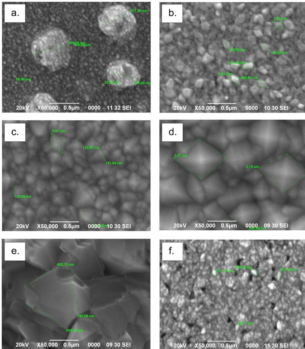
Figure 8 SEM microstructure of FTO thin film on 50,000 $\times$  magnification: (a) 2%-300-5 $^\circ$ ; (b) 2%-300-10 $^\circ$ ; (c) 2%-300-20 $^\circ$ ; (d) 2%-300-30 $^\circ$ ; (e) 2%-300-40 $^\circ$ ; (f) 0%-300-20 $^\circ$
